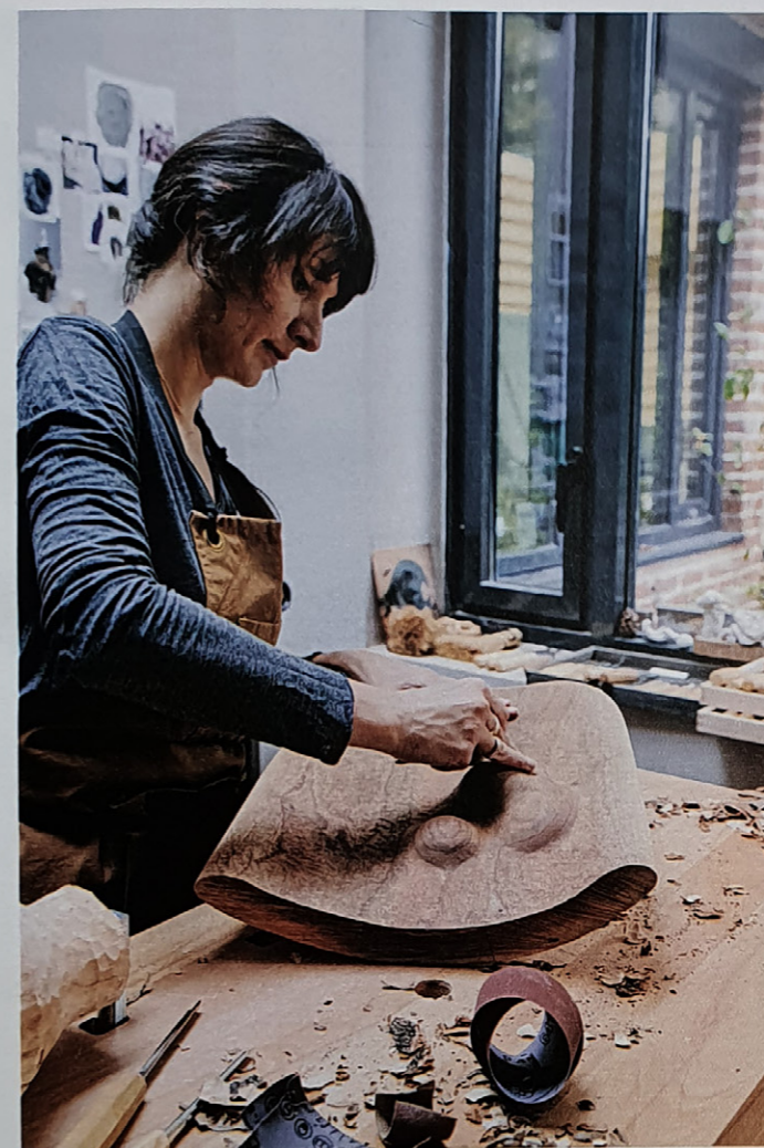
Kethevane au travail sur l'établi, sculptant à la gouge une pièce de bois après l'avoir dégrossie avec des outils électriques.
